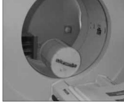
Şekil 3. Dönen detektörlü (yarım halka) sistemlerde detektör kontrolü
