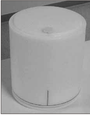
Şekil 8. Atenüasyon düzeltme faktörlerinin hesaplanmasında kullanılan fantom
