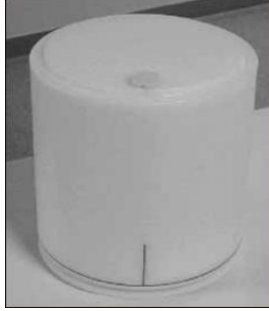
Şekil 20. Atenüasyon düzeltme faktörlerinin hesaplanmasında kullanılan fantom
