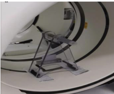
Şekil 1. Günlük KK pozisyonunda bir kaynak tutucu ile foton çoğaltıcıları, enerji ve zaman çözünürlüklerini kontrol etmek ve görsel inceleme için sinogram elde etmek için kullanılır
